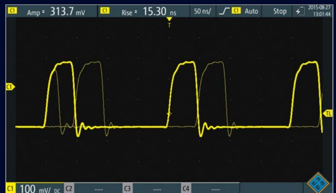
Le système d'acquisition haut débit du R&S®Scope Rider capture jusqu'à 50 000 formes d'ondes/s et dévoile toutes les anomalies de signaux rares et inattendues.
